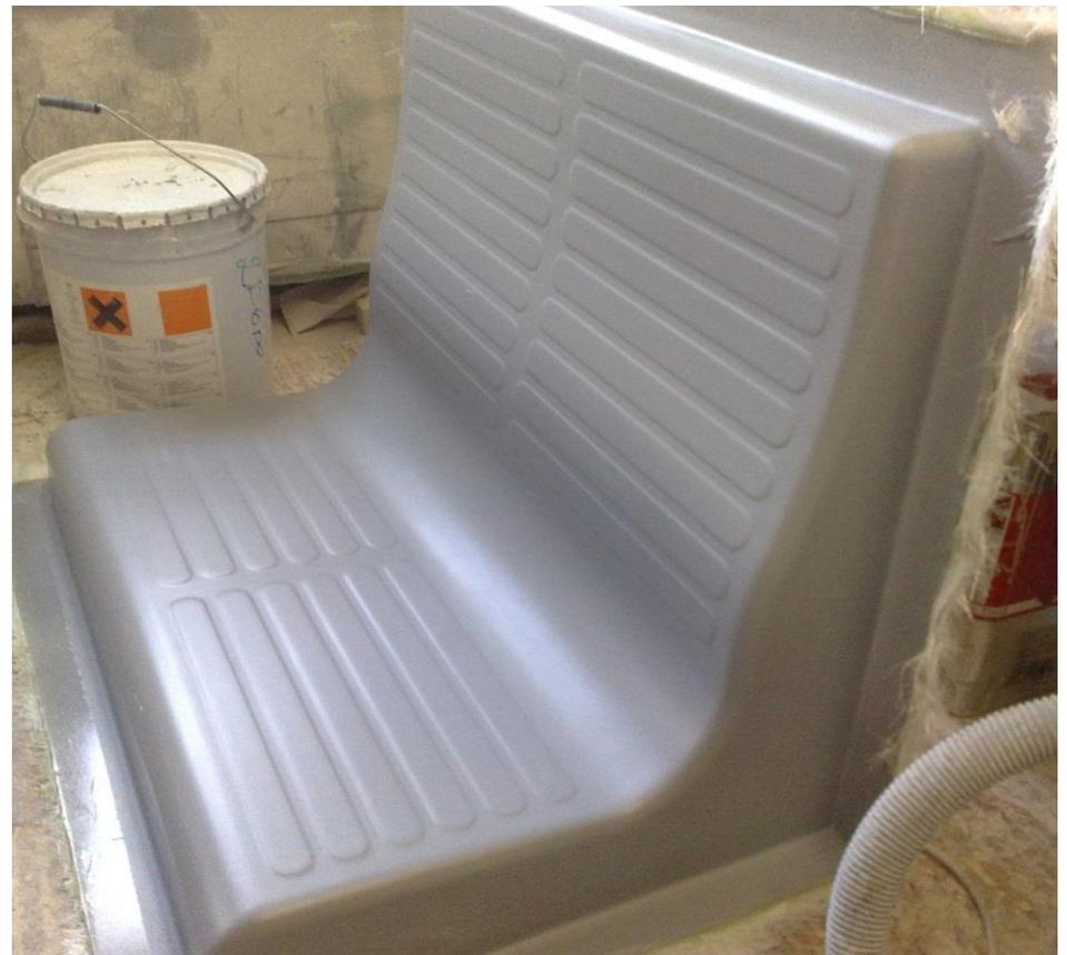
Стеклопластиковые панели с полимерными пожаробезопасными нагревателями (тёплые полы, панели душевых кабин, обогреватели ног машинистов и др.)
